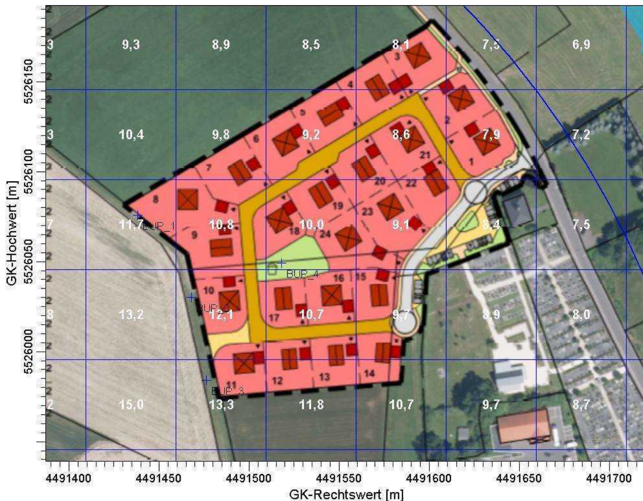
Abbildung 6-1: Geruchshäufigkeiten Zusatzbelastung, aus Rechenlauf unter Verwendung der Wetterdaten der Station Weiden (Ausschnitt des geplanten Neubaugebiets, (Auswertung der Geruchshäufigkeiten und Zellenwerten nach GIRL, 50 m Zellengröße) 9
