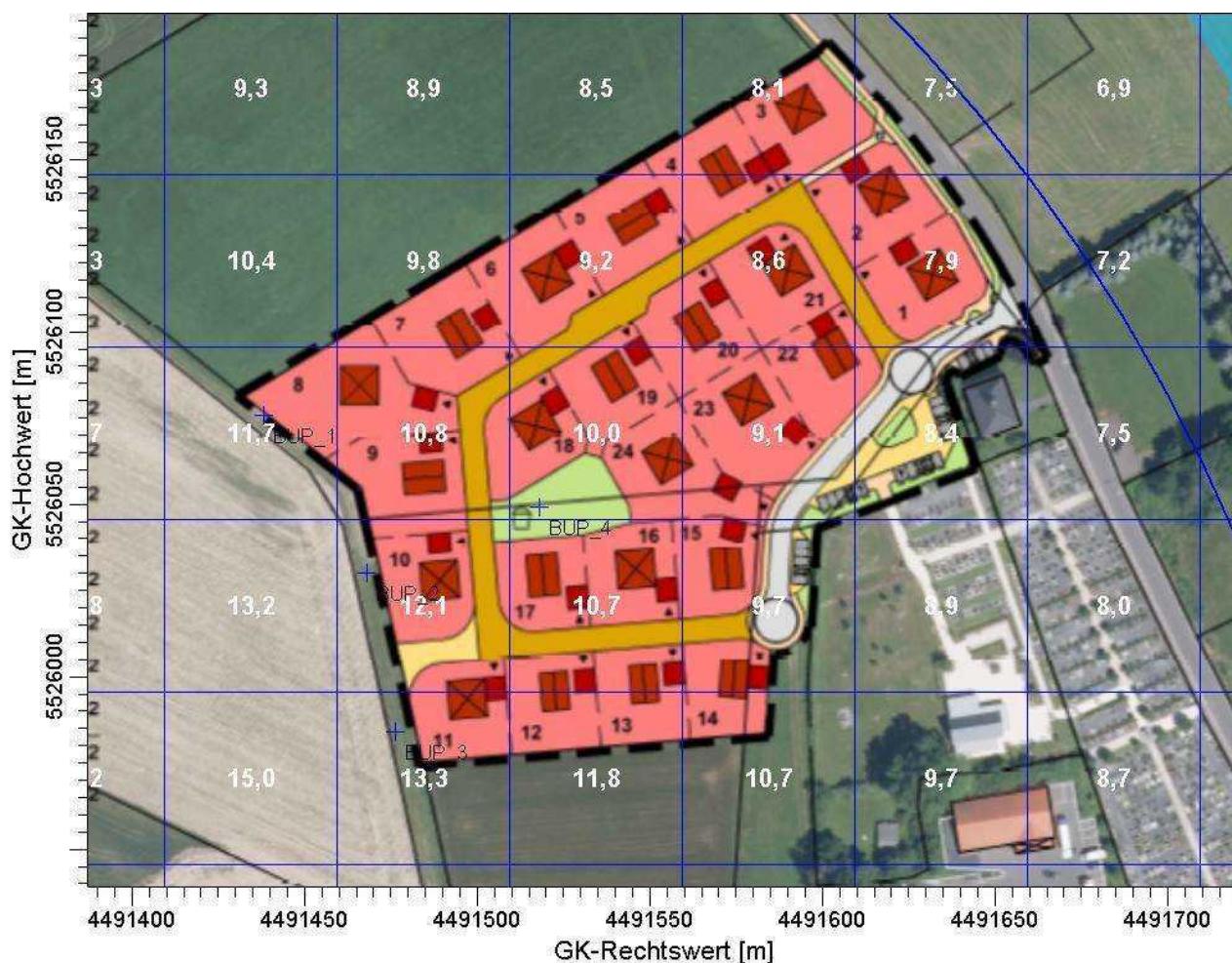
Abbildung A3: Geruchshäufigkeiten Zusatzbelastung, aus Rechenlauf unter Verwendung der Wetterdaten der Station Weiden (Ausschnitt mit 50 m-Gitter für die Auswertung der Geruchshäufigkeiten und Zellenwerten nach GIRL, geplantes Neubaugebiet) 13
